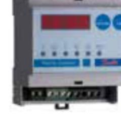
*Elektronischer Thermostat EFET 316* zur DIN-Schienen-Montage, zu ergänzen mit einem Leitungs- und einem Witterungsfühler. Einsetzbar zur Regelung von Dachrinnenheizungen bis zu 30 m Dachrinnenlänge.
