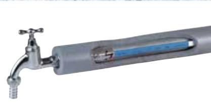
**Die Begleitheizbänder sind selbstlimitierend\*, d.h. unter anderem, dass die Wärmeabgabe des Heizbandes von der effektiven Temperatur des zu schützendes Rohres abhängig ist. Dies ist eine ökonomische und dennoch zuverlässige Methode, Rohre eisfrei zu halten und Bauschäden durch geplatzte Rohre zu vermeiden.**
