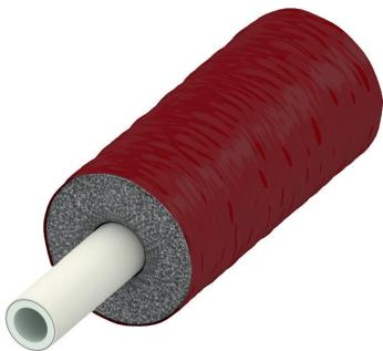
**TECEflex Mehrschichtverbundrohr PE-Xc/Al/PE-RT vorgedämmt,
