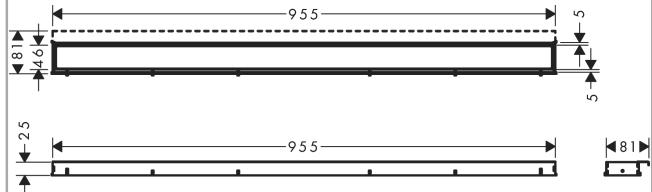
**RainDrain Match****Fertigset Duschrinne 1000 mit höhenverstellbarem Rahmen**Oberfläche: **Edelstahl gebürstet** Artikelnummer: **56041800**
