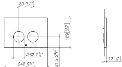
**Betätigungsplatte für WC-UP-Spülkasten der Firma Geberit , rund - Platin
