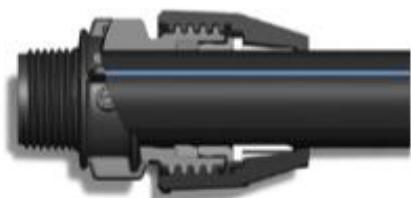
Das Rohr durch den Dichtring bis zum zweiten Anschlag einschieben. Wird der zweite Anschlag spürbar, befindet sich das Rohr in der richtigen Position.
