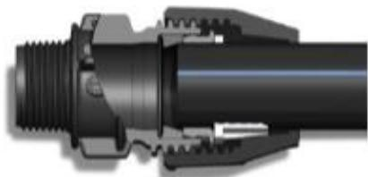
Das Rohr bis zum ersten Anschlag einschieben. Nun hat das Rohr den Dichtring erreicht.
