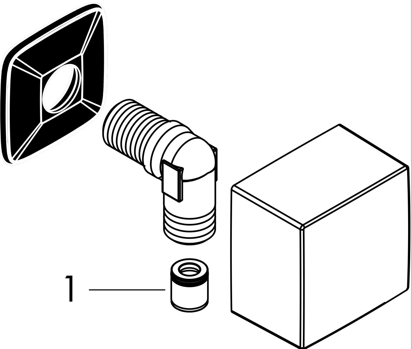
**FixFit****Wandanschluss Square mit Rückflussverhinderer**Oberfläche: **Polished Gold Optic** Artikelnummer: **26455990**
