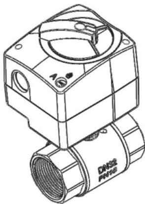
Positionsanzeige: **Rot:** Kugelhahn geöffnet,
