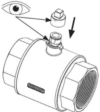
DIN Adapter auf Spindel stecken. Markierung von Wellenadapter muss parallel zur Flanke Spindel stehen.
