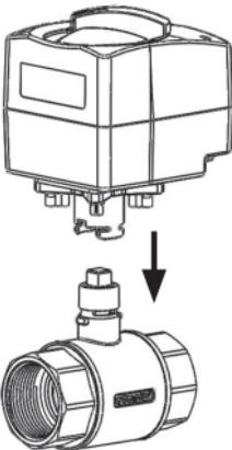
Stellantrieb auf Kugelhahn stecken.
