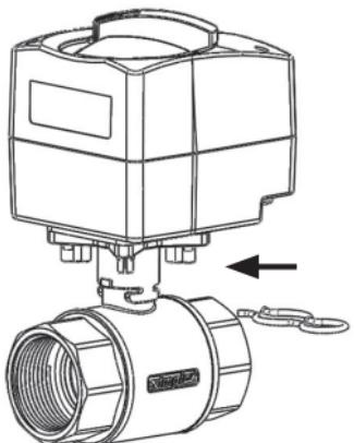
Federklammer zur Sicherung auf Adapter stecken.
