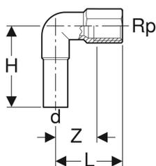
Werkstoff | CrNiMo-Stahl 1.4401 (DIN EN 10088)
