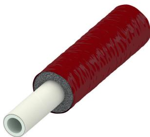
**TECElogo Mehrschichtverbundrohr vorgedämmt, 6 mm Dämmung, rot****Artikelnummer:** 8702116**Dimension:** 16 - RS 6 mm**Material:** PE-RT type II/Al/PE-RT type II**LE 1:** 75 m**LE 2:** 300 m**LE 3:** 600 m**Beschreibung:**
