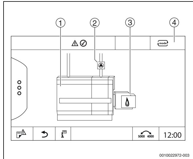
Bild 55 Funktionsprüfung Brenner
