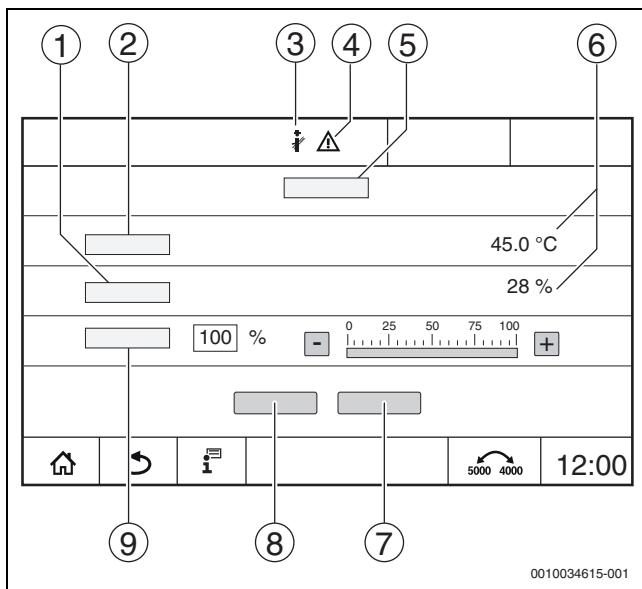
Bild 21 Anzeige Abgastest > Kesselleinstellungen
