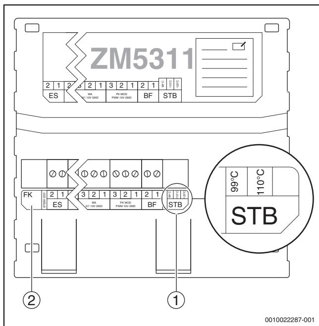
Bild 24 Elektronischer Sicherheitstemperaturbegrenzer beim ZM5311
