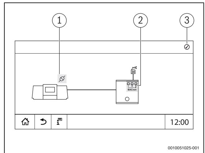
Bild 54 Kopplung des BACnet Gateway
