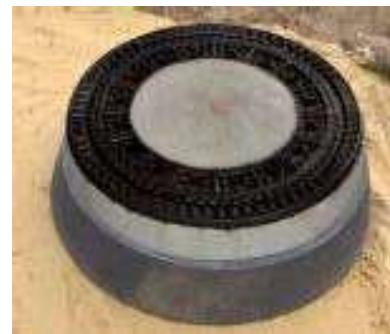
Aus Feinsand bzw. Splitt ist ein Auflager gemäß Vorgaben herzustellen. Zum Abziehen kann dabei z. B. eine Abziehschablone von Wavin verwendet werden. Das Dichtelement ON 600 ist dann zwischen der ersten und zweiten Außenwelle am Konushals zu montieren. Sowohl die Dichtung als auch die Dichtfläche des Auflageringes sind gleichmäßig mit Gleitmittel zu versehen.
