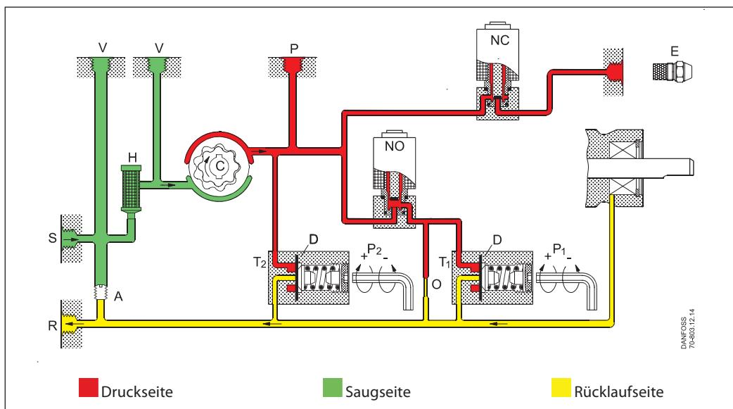
Über den Sauganschluss (S) wird das Öl über das Filter (H) in den Zahnradsetz gesaugt, wo der Druck erhöht wird.
