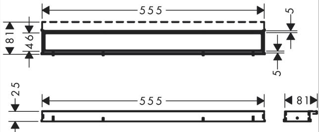
**RainDrain Match****Fertigset Duschrinne 600 mit höhenverstellbarem Rahmen**Oberfläche: **Schwarz** Artikelnummer: **56036610****Explosionszeichnung**
