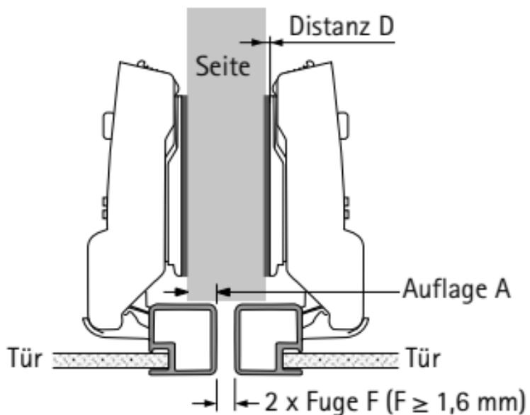
$$\begin{aligned} \text{Distanz D} &= 4,5 \text{ mm} + B - A \\ &= 4,5 \text{ mm} + 3 \text{ mm} - \text{Auflage A} \end{aligned}$$
