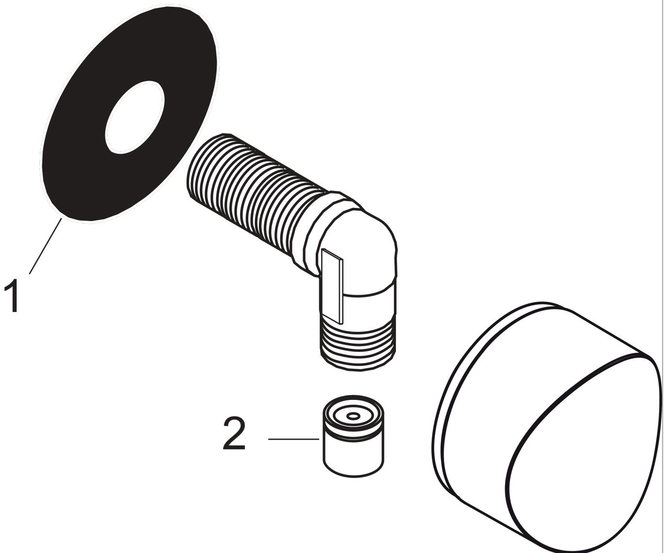
**FixFit****Wandanschluss S mit Rückflussverhinderer**Oberfläche: **Brushed Bronze** Artikelnummer: **26453140**
