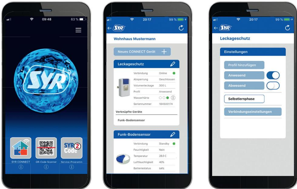
**Der SafeTech+ Connect kann auch ohne Internetverbindung bedient werden. In diesem Fall stehen jedoch Funktionen wie die Benachrichtigung per SMS oder E-Mail nicht zur Verfügung. Ebenso kann der SafeTech+ Connect dann nicht mit anderen Geräten wie beispielsweise dem SafeFloor Connect Funk-Bodensensor verknüpft werden.**
