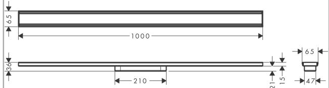
**RainDrain Original****Fertigset Duschrinne 1000**Oberfläche: **Edelstahl gebürstet**Artikelnummer: **56200800**
