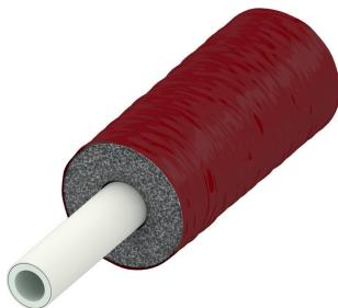
**TECElogo Mehrschichtverbundrohr vorgedämmt, 13 mm Dämmung, rot****Artikelnummer:** 8702220**Dimension:** 20 - RS 13 mm**Material:** PE-RT type II/Al/PE-RT type II**LE 1:** 50 m**LE 2:** 150 m**LE 3:** 300 m**Beschreibung:**
