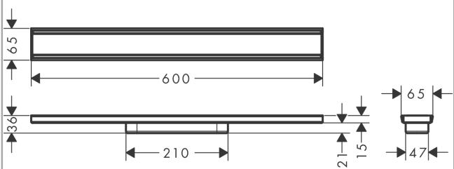
**RainDrain Original****Fertigset Duschrinne 600**Oberfläche: **Edelstahl gebürstet**Artikelnummer: **56196800**
