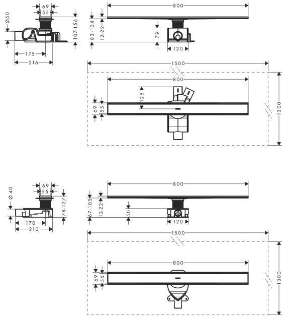
**RainDrain Allround****Komplettset Duschrinne 800 für Standard-/flache Installation**Oberfläche: **Edelstahl gebürstet** Artikelnummer: **56187800**
