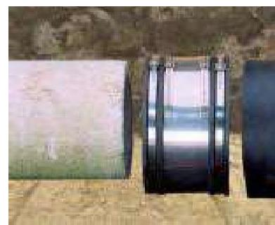
Für den Übergang auf alternative Rohrleitungen sind Übergangskupplungen zu verwenden. Bei Beton- und Steinzeugrohren ist die Außendurchmesserabweichung mit Ausgleichsringen zu kompensieren. Für Gussrohre ist die X-Stream Dichtung zu verwenden. Zum Verbinden von unterschiedlichen Rohrenden mittels Kupplungen bitte Herstellerhinweise beachten.
