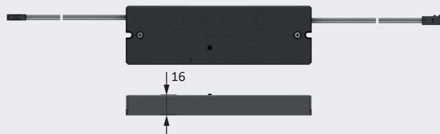
31.106.01 Erweiterungsset extension set 12VDC 60 Watt, Empfänger und EVG receiver and electronic ballast
