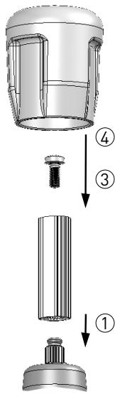
1. Langspindel auf Sternaufnahme des Ventils aufstecken.
