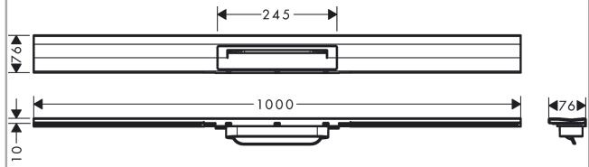
**RainDrain Flex****Fertigset Duschrinne 1000 kürzbar zur Wandmontage**
