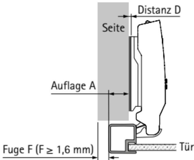
$$\begin{aligned} \text{Distanz D} &= 4,5 \text{ mm} + B - A \\ &= 4,5 \text{ mm} + 12,5 \text{ mm} - \text{Auflage A} \end{aligned}$$
