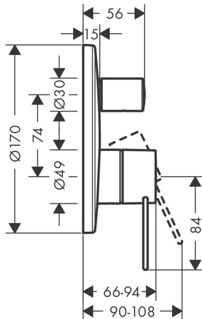
**AXOR Uno****Einhebel-Wannenmischer Unterputz mit Bügelgriff und integrierter Sicherungskombination
