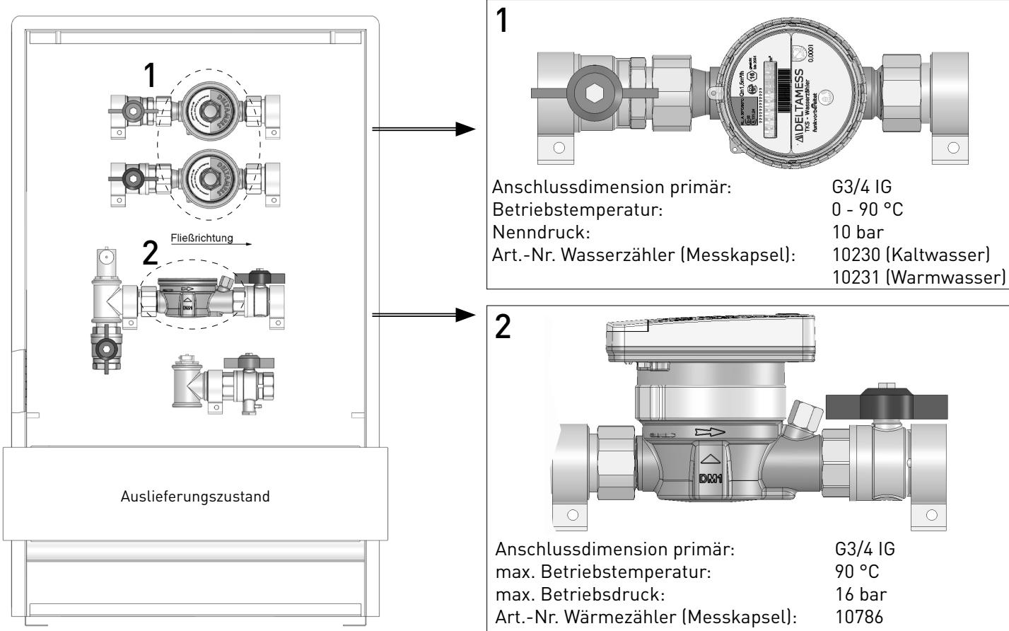
DELTAMESS-Zählerschränke für Wasser- und Wärmezähler inkl. Gehäuse sind ausgestattet mit
