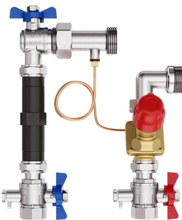
Das AB-PM-Anschlussset ist eine kompakte und zeitsparende Lösung. Es wurde für einen optimalen hydraulischen Abgleich in Heizkörpern mit horizontalen Strängen und in Fußbodenheizungen konzipiert. Eine differenzdruckabhängige Durchflussbegrenzung ist nun gewährleistet. Das Set kann in Kombination mit den meisten Verteilern, Wärmemengenzählern und Verteilerschränken verwendet werden.
