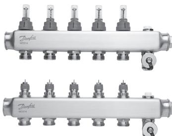
Der SSM-Verteiler wird zur Regelung des Wasserdurchflusses in Fußbodenheizungssystemen eingesetzt. Jedes Rohr des Fußbodenheizungssystems ist mit dem Verteiler verbunden. Dies ermöglicht eine individuelle Regelung des Wasserdurchflusses oder der Wärmezufuhr für jeden einzelnen Raum.
