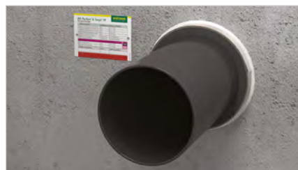
Verschluss von Rest- bzw. Ringspalten oder Durchbrüchen mit Tangit FP 550 2K-Brandschutz- Schaum. Voraussetzung: Ringspalt nimmt min. 40 % des Volumens der Kernbohrung ein.
