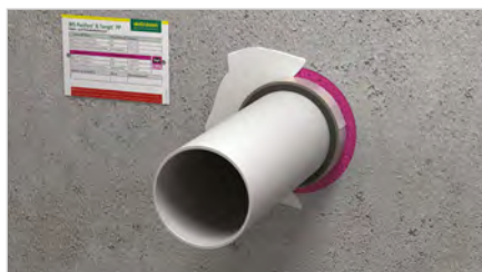
Verschluss von Rest- bzw. Ringspalten oder Durchbrüchen mit Tangit FP 550 2K-Brandschutz- Schaum. Voraussetzung: Ringspalt nimmt min. 40 % des Volumens der Kernbohrung ein.
