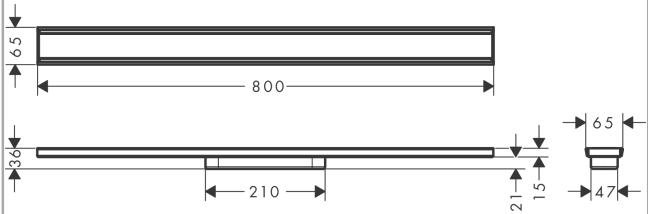
**RainDrain Original****Fertigset Duschrinne 800**Oberfläche: **Edelstahl gebürstet**Artikelnummer: **56198800**
